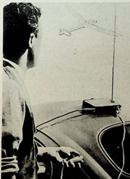
Bild 1. Die Teleskopantenne des Senders kann bis zu 90^{\circ} abgewinkelt werden, so daß man den Sender z. B. auf das Autodach legen und mit der Fern Taste bedienen kann. Das zweite Kabel des Senders ist hier zur Stromversorgung an die Autobatterie (Steckdose) angeschlossen
