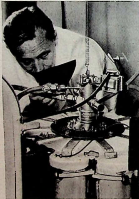
Kondensatorenatterie mit Versuchsaufbau zur Verschmelzung von Wasserstoffkernen
